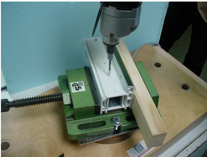
Bild 2 Prüfung des Überdrehmoments
