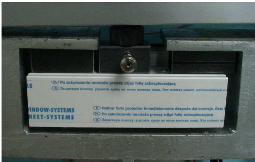
Bild 3 Prüfung der Schraubenauszugsfestigkeit
